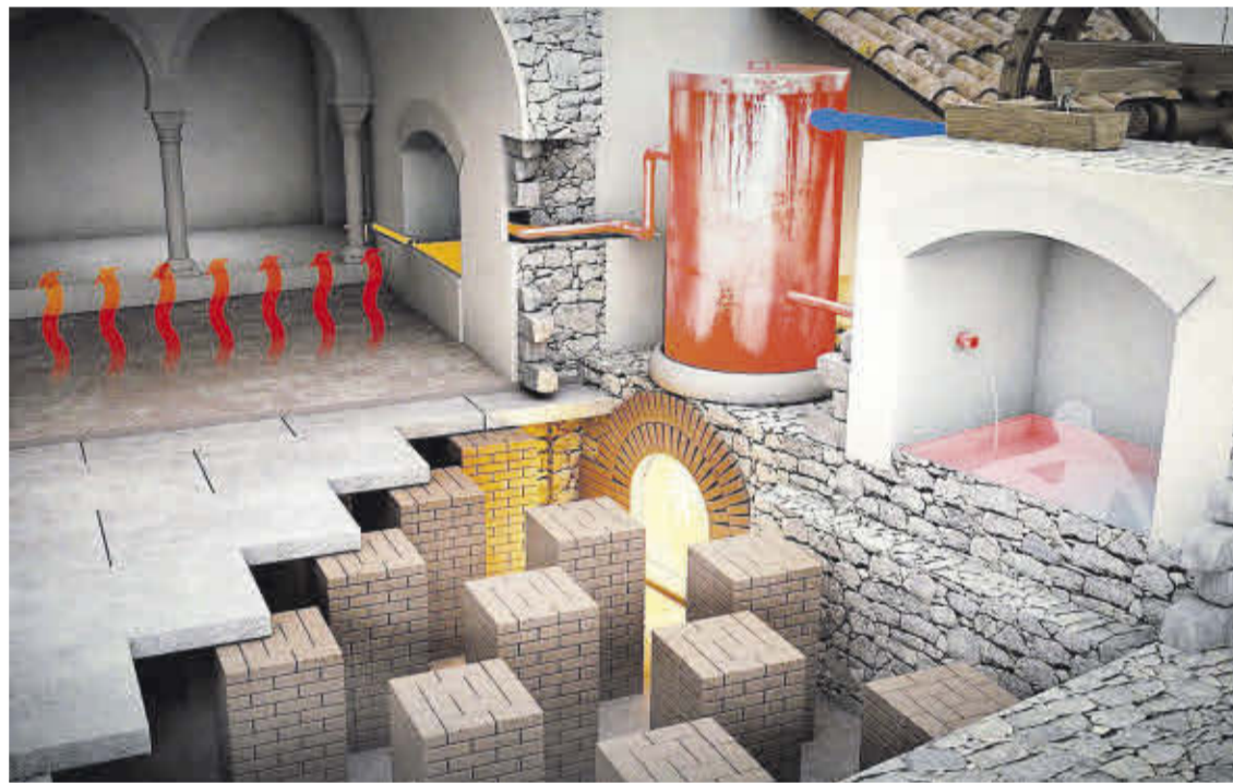
La recreació del sistema d'escalfament d'aire i aigua.
